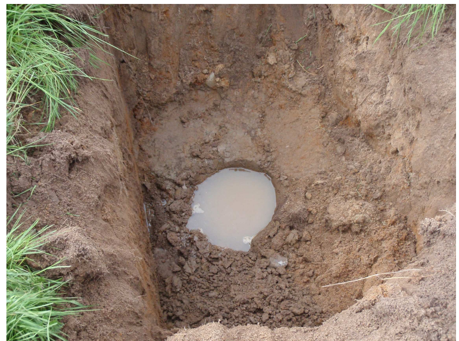
Foul Effluent Soakaway Tests.
